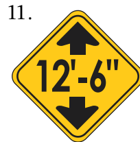
Espacio libre del puente
